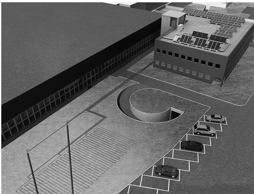
Fig. 6.3 – Rappresentazione di un impianto geotermico a sonde orizzontali e verticali (Caleffi, 2010).
